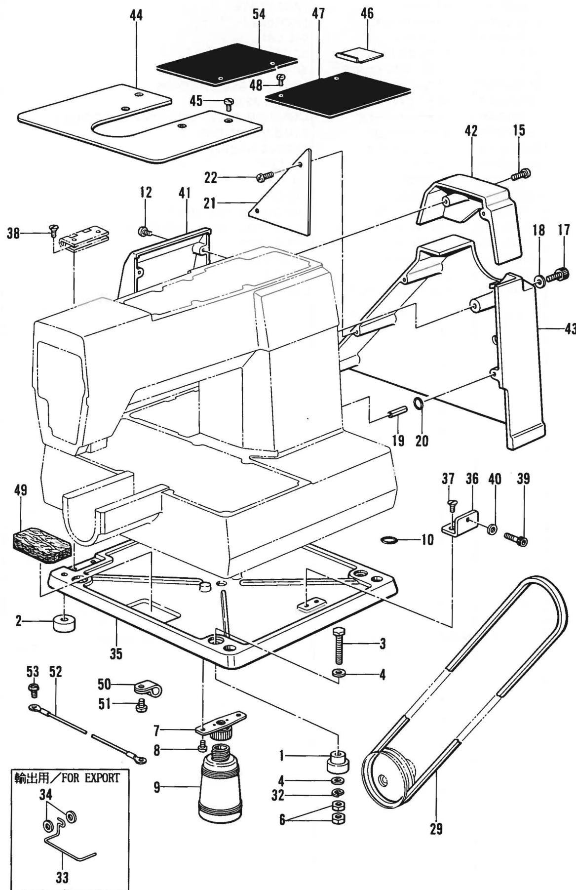
A2. 主体関係 / Machine body / Maschinengehäuse /
